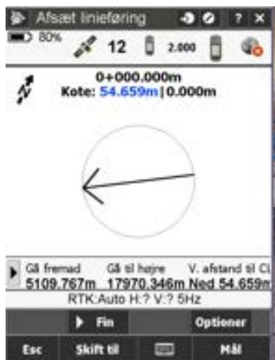
Hvis punktet måles som kontrol vil der blive gemt en masse oplysninger om det afsatte punkt. Tryk "Gem" for at gemme punktet på controlleren.
